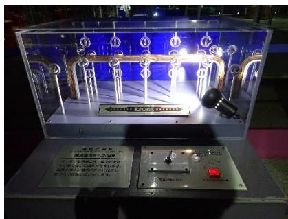
棒磁石が動きだし、電流の流れを変えると向きも変わる。
